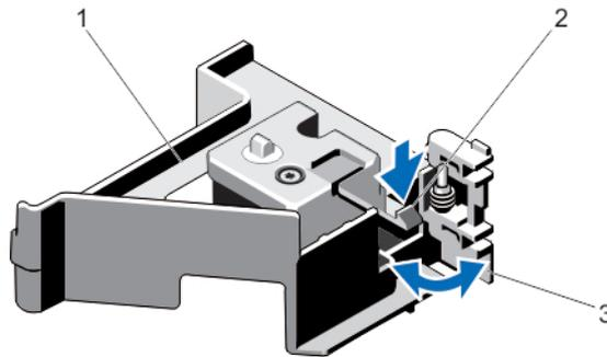
图 22: 打开和关闭 PCIe 卡固定器门锁
