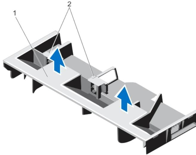
图 9: 卸下和安装冷却导流罩
