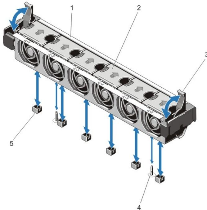
图 19: 卸下和安装冷却风扇部件
