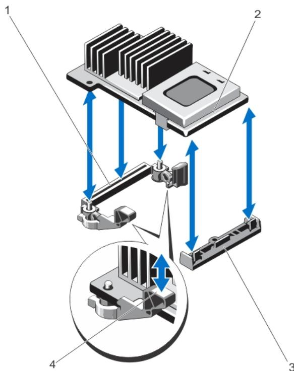
图 32: 卸下和安装集成的存储控制器卡
