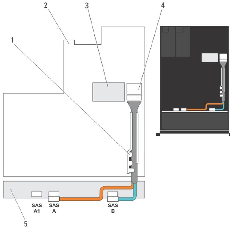
图 41: 布线图—3.5 英寸 (x12) SAS 背板
