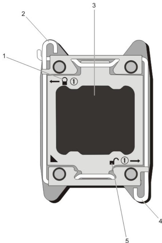
图 35: 处理器护盖打开与合上拉杆的顺序
