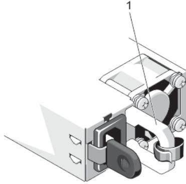
图 5: 交流电源设备状态指示灯
