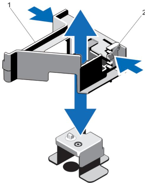
图 21: 卸下和安装 PCIe 卡固定器
