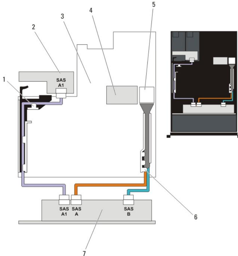
图 43: 布线图—可选 2.5 英寸 (x2) 硬盘驱动器背板 (背面)
