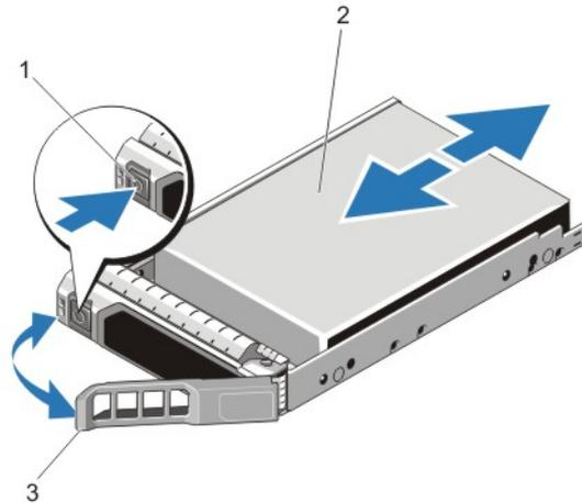
图 16: 卸下和安装热交换硬盘驱动器
