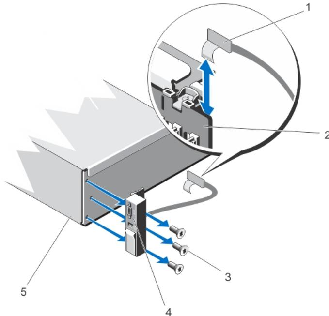
图 44: 卸下和安装 I/O 面板
