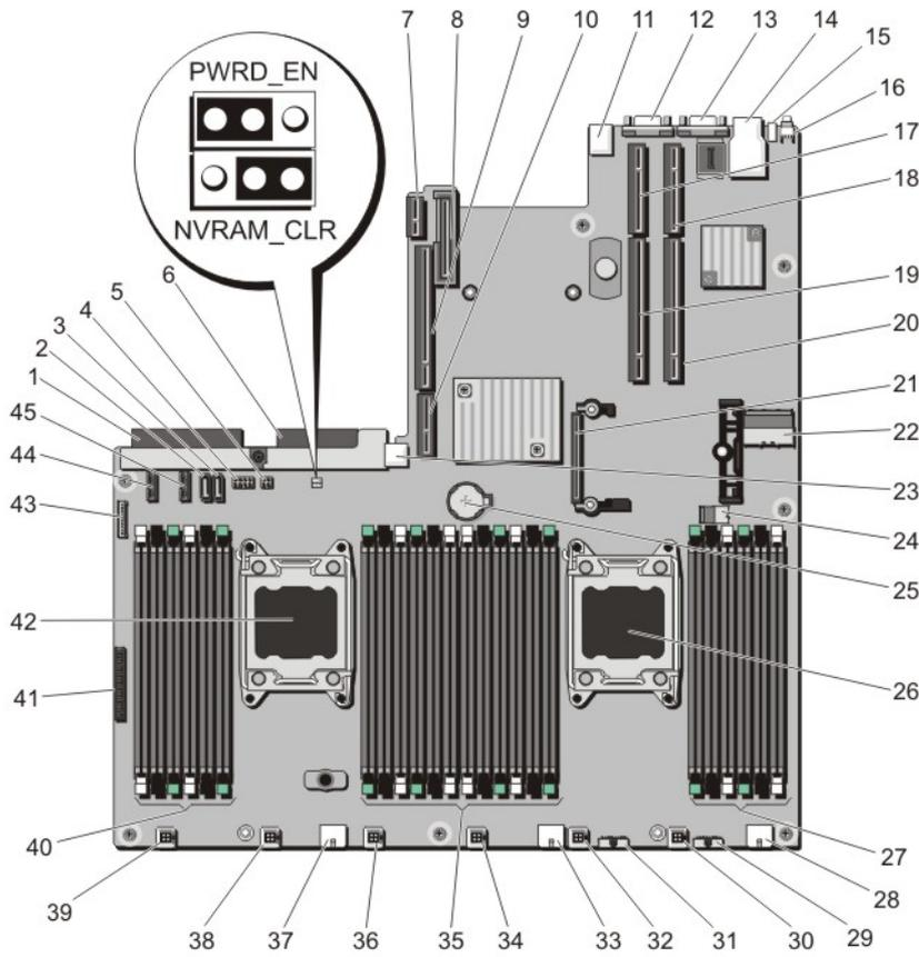
图 46: 系统板跳线和连接器
