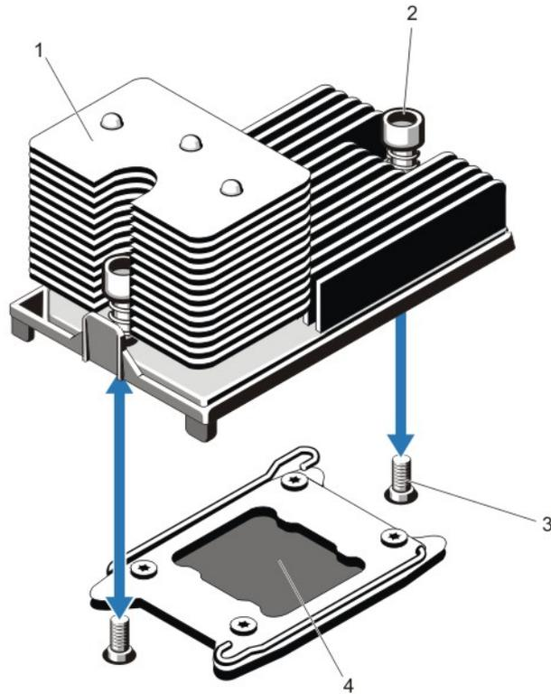
图 34: 卸下和安装处理器散热器
