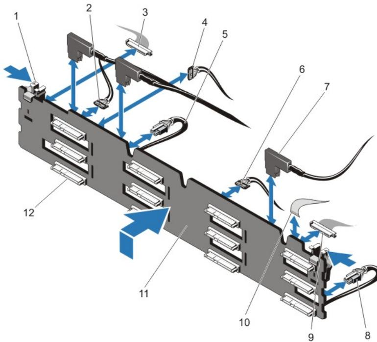
图 40: 卸下和安装 3.5 英寸 (x12) SAS 背板
