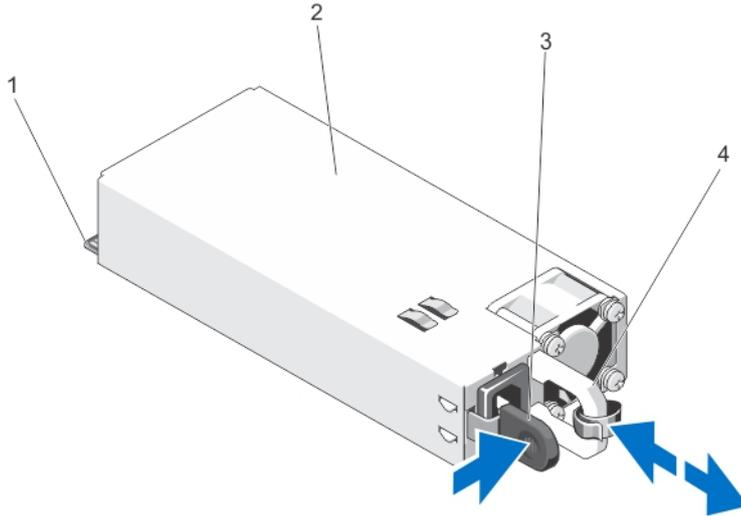
图 37: 卸下和安装交流电源设备
